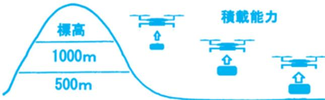
また、余裕ペイロードは機体の個体差などの要因でも変化しますので、散布飛行する立地条件を十分に確認し、農薬の積載量を決めて下さい。
