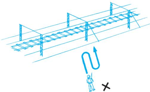
⑫ 高圧線、変電所、電波塔及び無線施設等の施設の付近ならびに多数の人が Wi-Fi などの電波を発する電子機器を同時に利用する場所では、電波障害等により操縦不能になることが懸念されるため、十分な距離を保ってマルチローターを飛行させて下さい。
